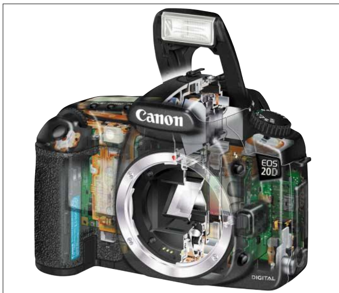
Ein Blick in das Gehäuse der EOS 20D zeigt das mit Technik vollgestopfte Innenleben von Digitalkameras.
