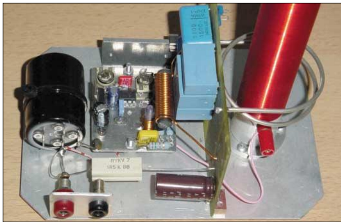
Bild 9: Detailsicht des Primärkreises beim Mini-Tesla
