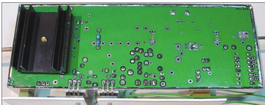
Bild 13: Lediglich die Spannungsregler IC2 und IC3 sind auf der Unterseite unterzubringen, wodurch sich leicht kleine Kühlbleche anbringen lassen. Links im Bild ist ferner der Kühlkörper zu erkennen, der an der in Bild 10 gezeigten Messingschraube zu befestigen ist.
