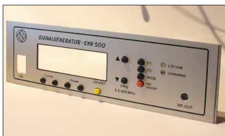
Bild 14: Fertig belichtete Alucorex-Frontplatte mit bereits montierten Tastern
