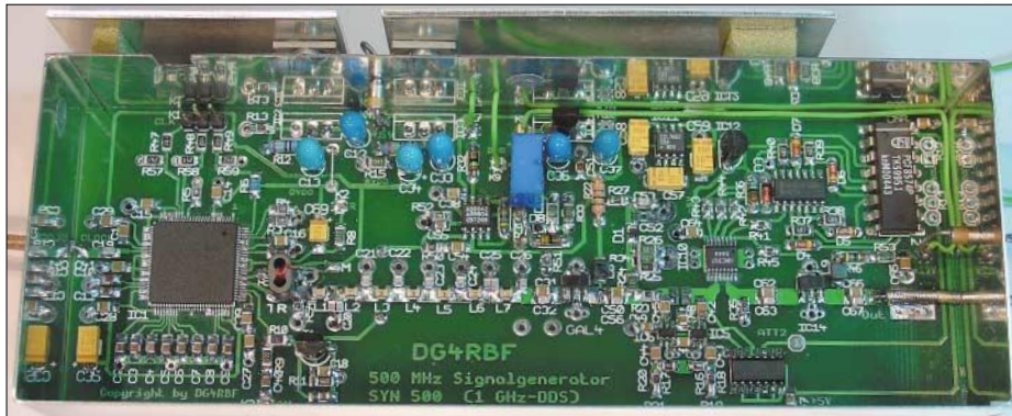
Bild 12: Die Bestückung des gesamten DDS-Generators erfolgt auf der Oberseite; anschließend wird die Platine in einem Weißblechgehäuse untergebracht.
