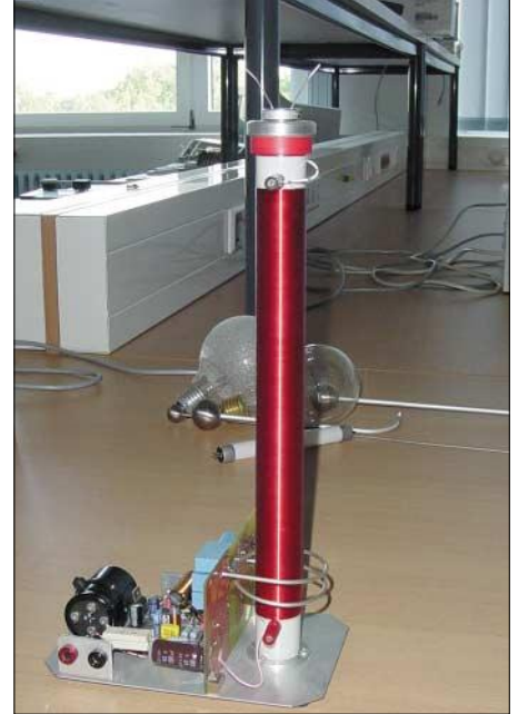
Bild 10: Nach dem Anschluss einer 30-V-Spannung ist der kleine Tesla-Transformator für die HF-Vorführung bereit. Fotos: DB1NV
