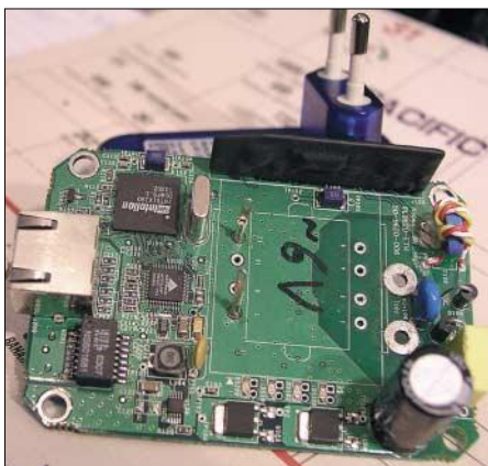
Bild 4: Innenansicht des PLC-Modems von Devolo Fotos: OE3MZC
