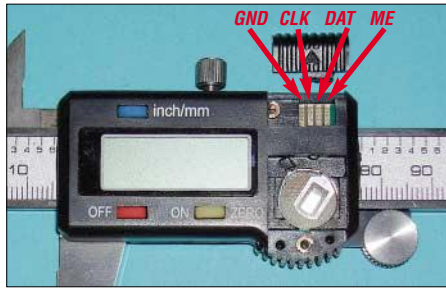
Bild 3: Oberhalb der Batteriekammer besitzt dieser Messschieber eine Abdeckung, hinter der sich das Interface verbirgt. ME ist mit der Schirmung des Kabels zu verbinden.
