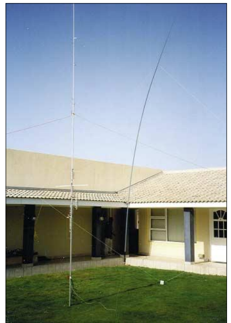
Unsere „Antennenfarm“ in Walvis Bay (V5): HF9V und Eigenbau-Quad an einer Angelrute
