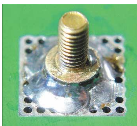
Bild 10: Eine M3 × 6-Messingschraube mit Zylinderkopf ist hier aufzulöten; zuvor Stirn- und Seitenflächen abschmiegeln.
