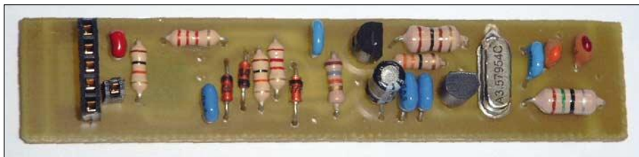
Der 80-m-Sender AS804a des AATiS für den Einsatz bei Foxoring-Wettbewerben. Foxoring ist vergleichbar mit einer Fuchsjagd, nur dass die Sender geringere Reichweiten haben, dafür allerdings die Standorte ungefähr bekannt sind. Der Sender ist mikrocontrollergesteuert und wird mit drei Mignon-Batterien (AA) betrieben. Foto: DF6TZ
