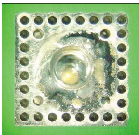
Bild 9: Die Massefläche unter IC1 ist durch die Bohrung in der Platine gut mit Masse zu verlöten; auch der hier zu erkennende Hohlraum ist noch mit Lötzinn aufzufüllen.
